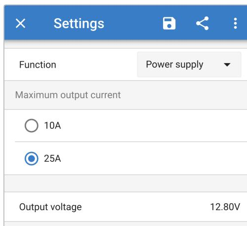
Также можно включить режим низкого тока в режиме источника питания и указать желаемое выходное напряжение.
