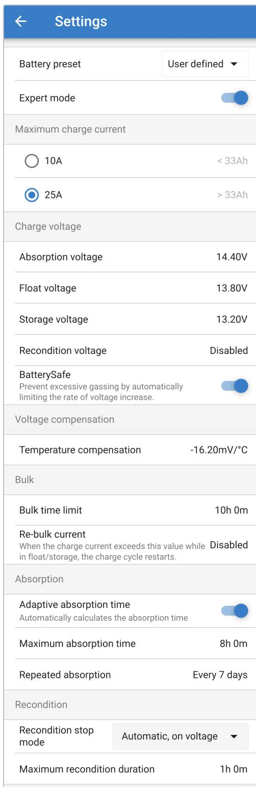
Чтобы получить доступ к экспериментальному режиму и развернуть меню дополнительных настроек, войдите в меню дополнительных настроек и включите переключатель «Экспертный режим».
